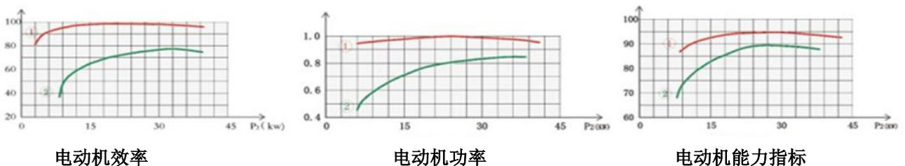
1. 超高节能永磁同步电动机    2. 异步电动机
